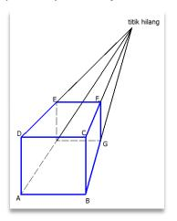
Pada gambar perspektif dengan satu titik hilang, bagian muka diambil dari salah satu sisi/bidang benda (lihat bidang ABCD) yang dilihat dari sudut tegak lurus dengan permukaan sehingga proyeksinya sesuai dengan bentuk yang sebenarnya, kemudian semua titik sudut di tarik ke satu titik yang sama (titik hilang). Dalam hal ini, panjang sisi miring akan tergantung pada sudut kemiringan terhadap garis horizontal. Perhatikan materi tentang cara membuat proyeksi sisi miring berikut:
