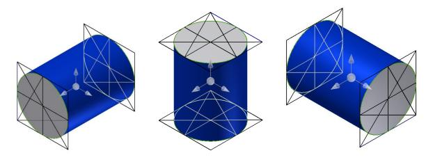
Pada contoh 2, adalah cara untuk membuat silinder pada isometric. Terlihat yang paling kiri bila silinder menghadap kekiri, maka menggunakan bantuan sisi kubus sebelah kiri. Silinder yang tengah menghadap ke atas, maka menggunakan bantuan sisi kubus yang mengarah ke atas, dan yang paling kanan merupakan silinder yang miring ke akanan, menggunakan bantuan sisi kubus sebelah kanan.
