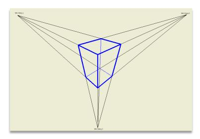
Pada gambar dengan tiga titik hilang ini, semua sisi dari benda akan mengalami pemendekan ukuran dari yang sebenarnya, baik yang keara sumbu x, y maupun yang kearah sumbu z.
