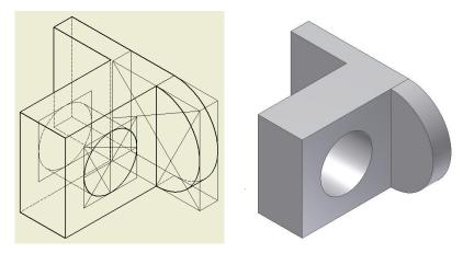
Untuk membuat benda tersebut, cara yang digunakan sama, yaitu terlebih dahulu membuat bentuk dasar benda yang berupa balok tiga dimensi yang mempunyai kemiringan 120° sumbu 3 dimensinya. Selanjutnya untuk bentuk lubang, karena mempunyai bentuk dasar lingkaran, maka cara pembuatannya dengan menggunakan teknik pembuatan ellips , seperti pada contoh 1 dan contoh 2.
