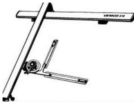
Gambar 3a Mesin Gambar
